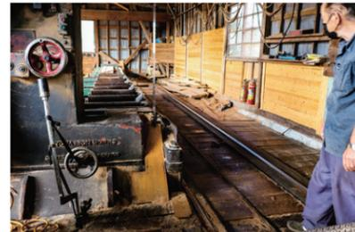
木を乗せた送材車がこのレールの上を歩き来して、中央にある帯状ののこぎりによって切断されていく
