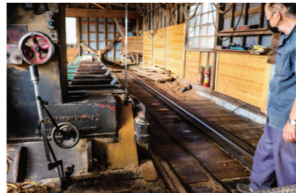
木を乗せた送材車がこのレールの上を走り来して、中央にある帯状ののこぎりによって切断されていく
