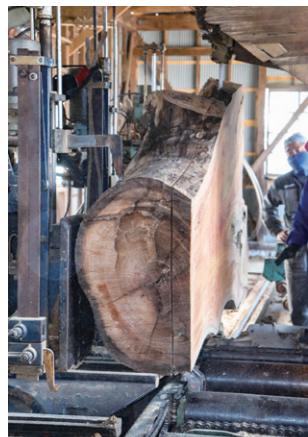
町内の手作り家具工房「木歎坊」の家具職人、山上さんと一緒に仕事をすることも。写真は2021年3月の製材の時の様子。山上さんのお客様からのオーダーで、神奈川県大和市の敷地内から台風で倒れたケヤキを運び出し、英夫さんが製材。山上さんの工房であと2年ほどかけて乾燥させてから、テーブルとイスになる予定
