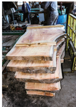
町内の手作り家具工房「木歎坊」の家具職人、山上さんと一緒に仕事をすることも。写真は2021年3月の製材の時の様子。山上さんのお客様からのオーダーで、神奈川県大和市の敷地内から台風で倒れたケヤキを運び出し、英夫さんが製材。山上さんの工房であと2年ほどかけて乾燥させてから、テーブルとイスになる予定
