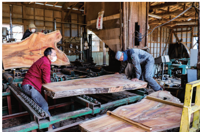
町内の手作り家具工房「木歎坊」の家具職人、山上さんと一緒に仕事をすることも。写真は2021年3月の製材の時の様子。山上さんのお客様からのオーダーで、神奈川県大和市の敷地内から台風で倒れたケヤキを運び出し、英夫さんが製材。山上さんの工房であと2年ほどかけて乾燥させてから、テーブルとイスになる予定
