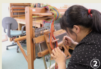
② 糸を箆（おさ）に通す作業。整経台からはずした糸を一目ずつ通していきます
