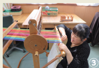
③ たて糸ローラーに糸を巻き取る作業。布に糸を結び付けます。この作業の後、織り始めとなります
