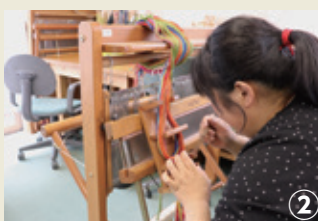
② 糸を箆（おさ）に通す作業。整経台からはずした糸を一目ずつ通していきます
