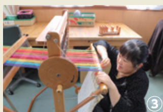
③ たて糸ローラーに糸を巻き取る作業。布に糸を結び付けます。この作業の後、織り始めとなります
